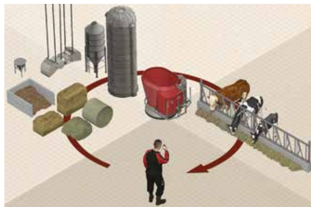
Como trabalha o sistema de alimentação automática LELY VECTOR
