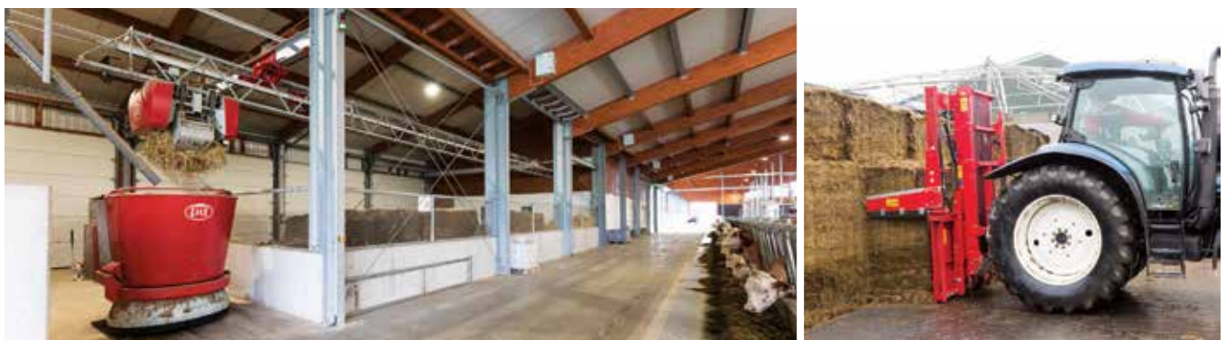
A garra recolhe as forragens e outros alimentos dos blocos ou rolos no chão da cozinha. O robot pode também ser fornecido a partir de silos ou outros doseadores
