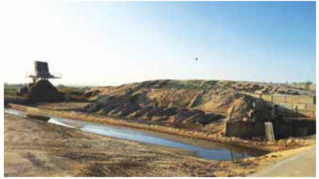
Espaço de recuperação da areia usada nas camas dos animais através de lavagem por onda de água e posterior secagem
